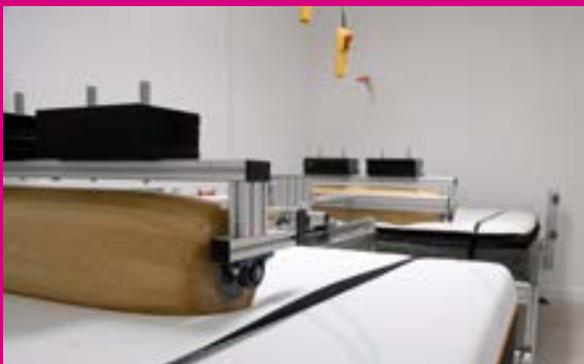
**DURABILITÀ** Per il test di "fatica", si passa avanti e indietro sul materasso, per 30mila volte, un grosso cilindro da 140 kg, simulando un uso di circa 10 anni. Trascorse 20 ore, si misurano gli eventuali cambiamenti dovuti all'usura.
