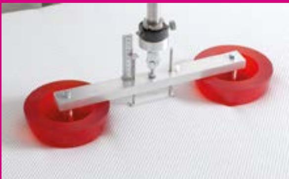
**ELASTICITÀ** Premendo due semisfere ravvicinate si misura se anche la zona tra le due semisfere subisce una pressione: un buon materasso deve risultare "schiacciato" solo nelle zone direttamente sollecitate, non in quelle vicine.
